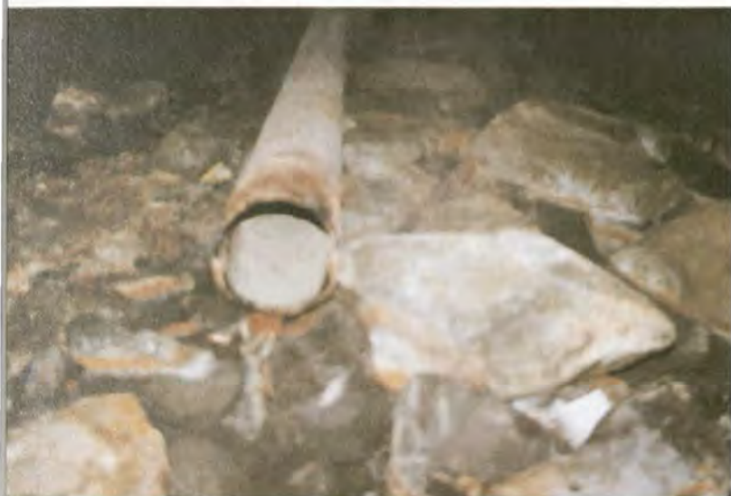
Resim 8: Demir Boruda Korozyon nedeniyle Meydana Gelen Çürümeye, Çökelen Kireçtaşı ve Mineral Maddeler (Ş. Bekişoğlu, Ocak 2001)
