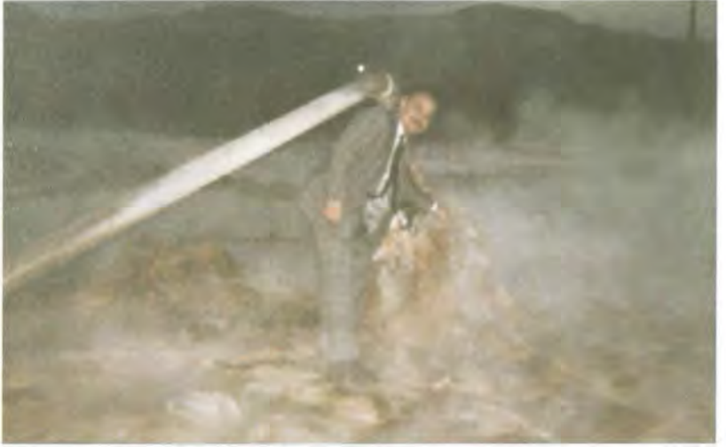
Resim 1: Batman İli Jeotermal Su Kaynağı Çıkışında Termometre İle Sıcaklık Ölçümü (N. Özel, Ocak, 2001)
