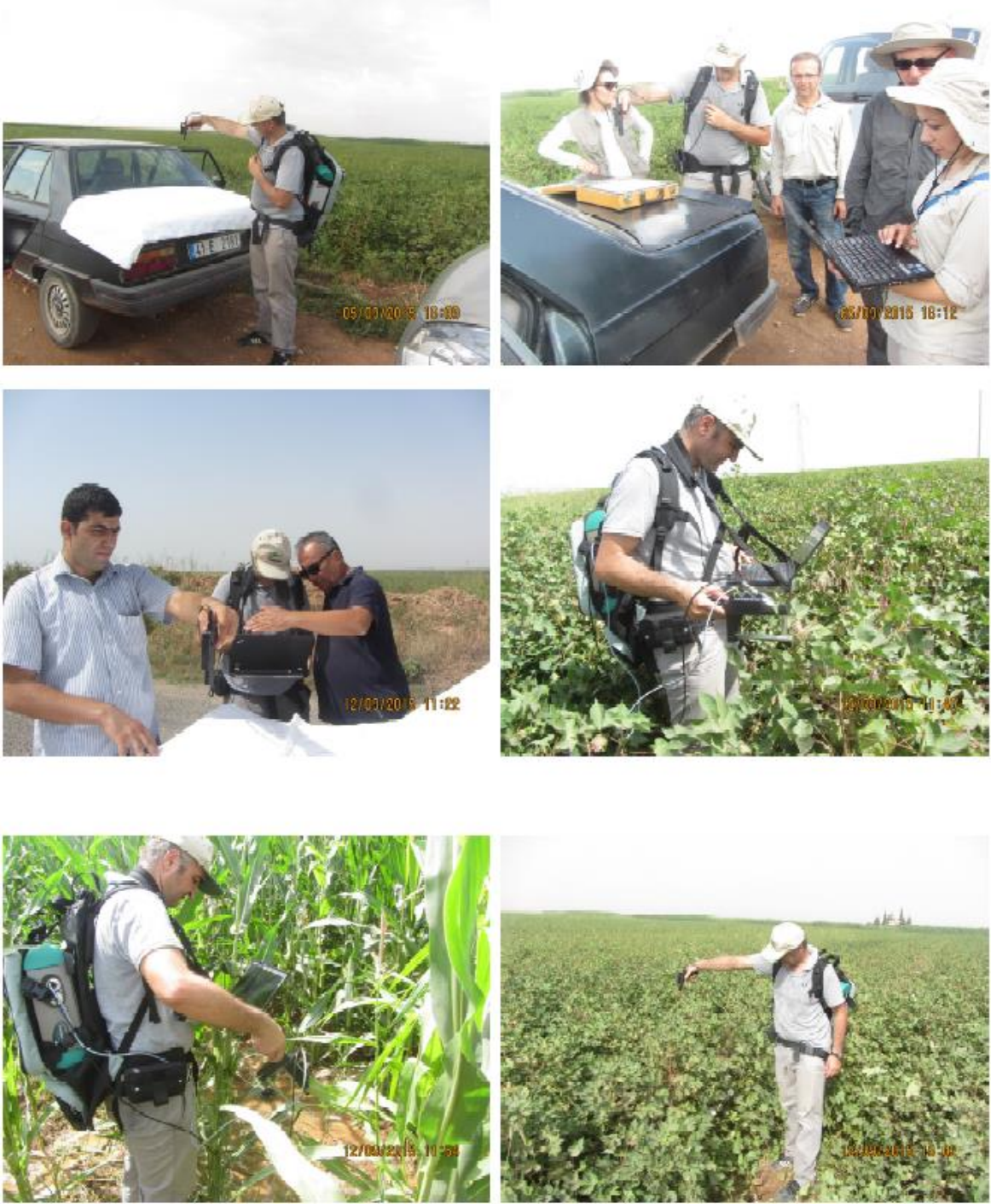
Şekil 61: ASD FieldSpec 3 Spektral Ölçümler (Plant Probe Pamuk, Plant Probe Mısır, Pistol Grip Pamuk Canopy, Tyvek Calibration, Spectralon (25 X 25 cm) Calibration)
