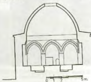
Çizim 56 BİRECİK HASAN BABA HAMAMI, SOYUNMALIK, A-A RÖLÖVE KESİDİ Rölöve: M. Acara-S. Gündüz-A. Durukan (Şubat 1998) Çizen: E. Eser (Nisan 1998)
