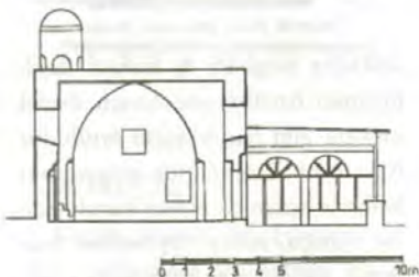
Çizim 20 BIRECİK TEKKE CAMII, A-A RÖLÖVE KESİDİ Rölöve : E. Eser-A. Şener-M. Mirmiroğlu (Eylül 1997) Çizen : E. Eser (Aralık 1997)
