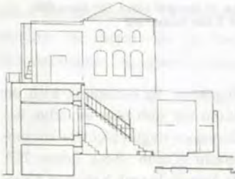
Çizim 80 BİRECİK HÜSEYİN ÖZATEŞ EVİ, A-A RÖLÖVE KESİDİ Rölöve : M. Akpolat-M. Acara-E. Eser (Mayıs 1998) Çizen : E. Eser (Haziran 1998)
