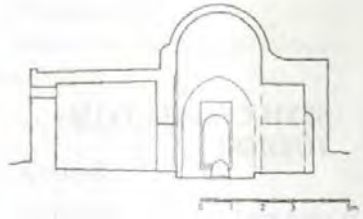
Çizim 65 BİRECİK ŞEYH CEMALETTİN TÜRBESİ, A-A RÖLÖVE KESİDİ Rölöve : M. Acara-S. Alp-S. Gündüz (Şubat 1998) Çizen : M. Acara (Şubat 1998)
