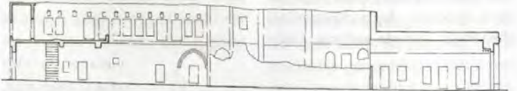
Çizim 45 BIRECİK BELEDİYE HANI, A-A RÖLÖVE KESİDİ Rölöve : M. Akpolat-S. Alp-A. Durukan (Eylül 1997) Çizen : A. Aldemir (Kasım 1997)
