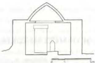
Çizim 62 BİRECİK SEYYİD ALI BABA TÜRBESİ, A-A RÖLÖVE KESİDİ Rölöve : M. Acara-S. Alp-S. Gündüz (Şubat 1998) Çizen : S. Gündüz (Mart 1998)
