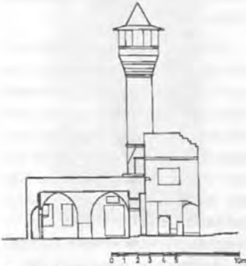
Çizim 32 BİRECİK ŞEYH SAADETTİN CAMİLİ, A-A RÖLÖVE KESİDİ
