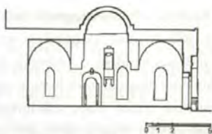
Çizim 30 BİRECİK ABD-İ KETHÜDA CAMİİ, B-B RÖLÖVE KESİDİ Rölöve : E. Eser-M. Görür-A. Durukan (Şubat 1998) Çizen : M. Görür (Mayıs 1998)
