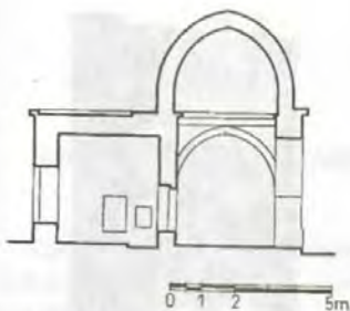
Çizim 137 SURUÇ ULU CAMII, A-A RÖLÖVE KESİDİ Rölöve : M. Terzi-S. Gündüz (Mayıs 1998) Çizen A. Şener (Haziran 1998)
