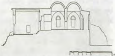
Çizim 158 BOZOVA BÜYÜKHAN KÖYÜ CAMİİ, A-A RÖLÖVE KESİDİ
