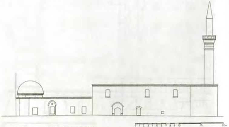
Çizim 4 BİRECİK ULU CAMII, DOĞU CEPHE RÖLÖVESİ Rölöve : M. Görür-B. Ceylan-M. Terzi (Eylül 1997) Çizen : B. Ceylan (Kasım 1997)
