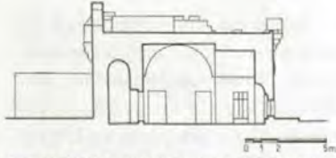
Çizim 39 BİRECİK ALABURÇ MESCİDİ, A-A RÖLÖVE KESİDİ Rölöve : M. Akpolat-B. Gökçe-A. Durukan (Eylül 1997) Çizim : B. Gökçe (Ocak 1998)
